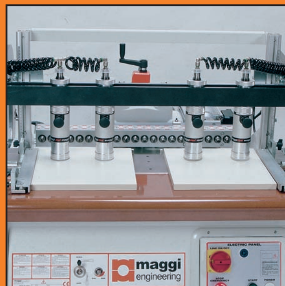
▲ Příklad současného obrábění dvou desek s použitím čtyř přitlaků
