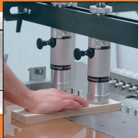
▲ Naše bezpečnostní přitlaky zabrání zranění obsluhy
