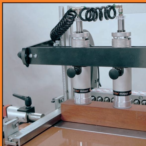
▲ Max. výška pod přitlaky je 80 mm
